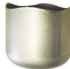
Test de la coupe d'emboutissage
